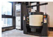
سیستم تست خستگی تیغه
